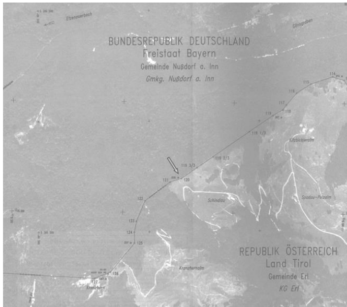
Abb 21: Ausschnitt aus dem Kartenblatt Nr. 20 der Grenzkarte des Grenzabschnittes „Scheibelberg-Bodensee“, Sektion I (vom Scheibelberg bis zum Inn bei Kufstein), Maßstab 1:5000; die Grenzlinienauftragung wird mit Orthophotos zur Geländedarstellung kombiniert; © BEV 2014 37
